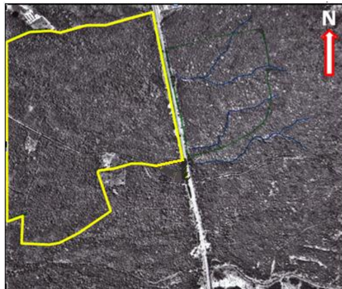
Imagen 28. Análisis fotogeológico vuelo C-2412 –Nótese la ausencia de procesos erosivos y movimientos en masa, así como la densa cobertura vegetal dentro de los predios
